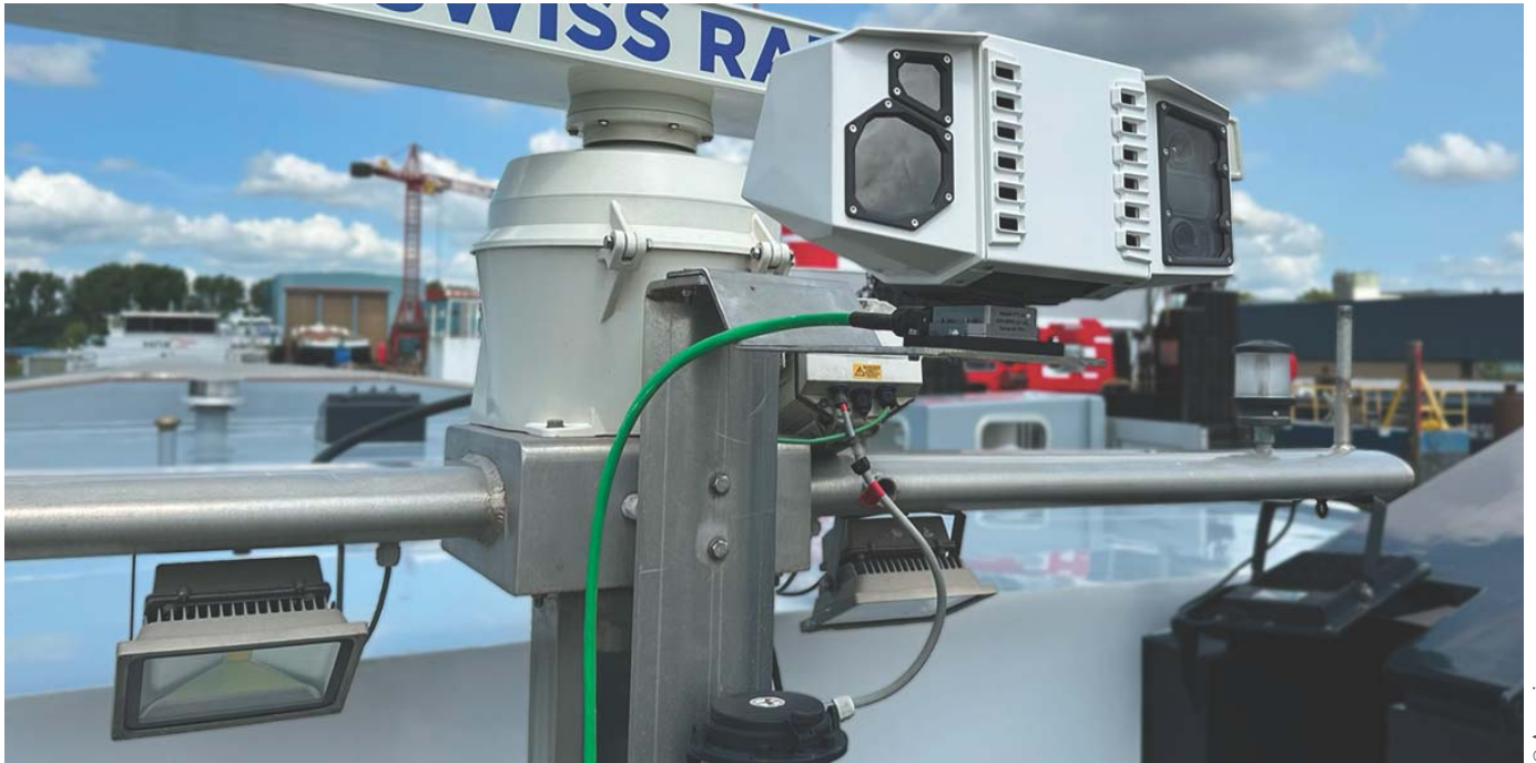
An Bord der »Niedersachsen 22« wurde mit der »Sentry« der Firma SEA.AI eine neue 360°-Umgebungsüberwachung ermöglicht
