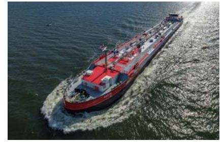
Die »Gas 94« war der erste Neubau mit neuem Antriebskonzept und Niedrigwasser-Eignung
